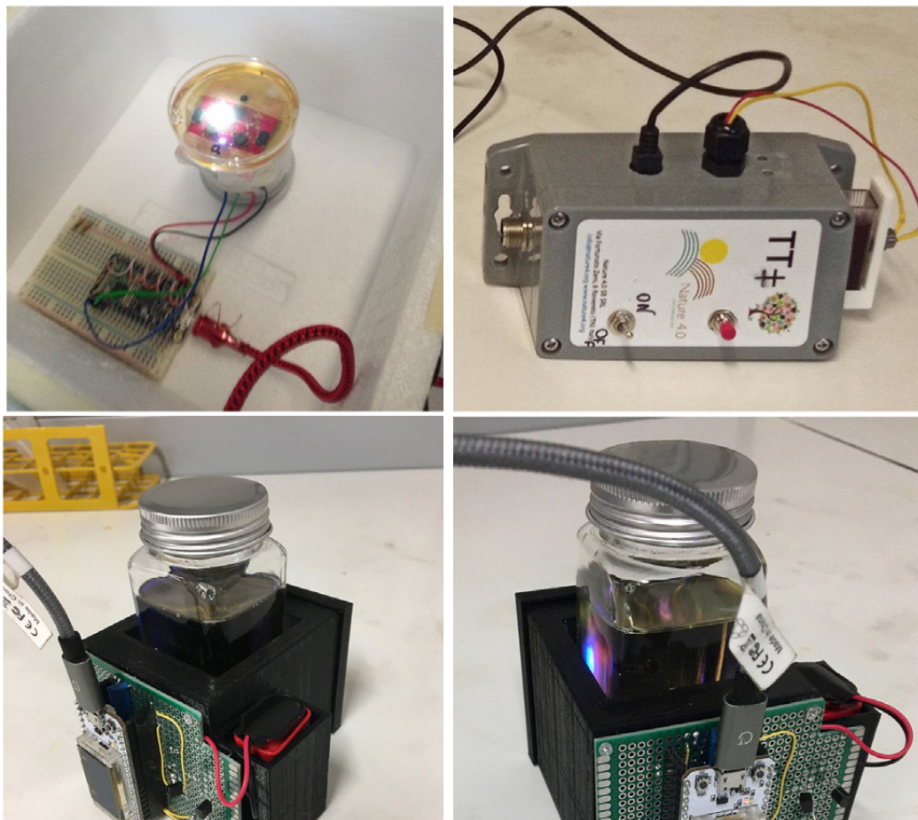
Sviluppo prototipo Vis-NIR a basso costo, funzionante in ambiente IoT
